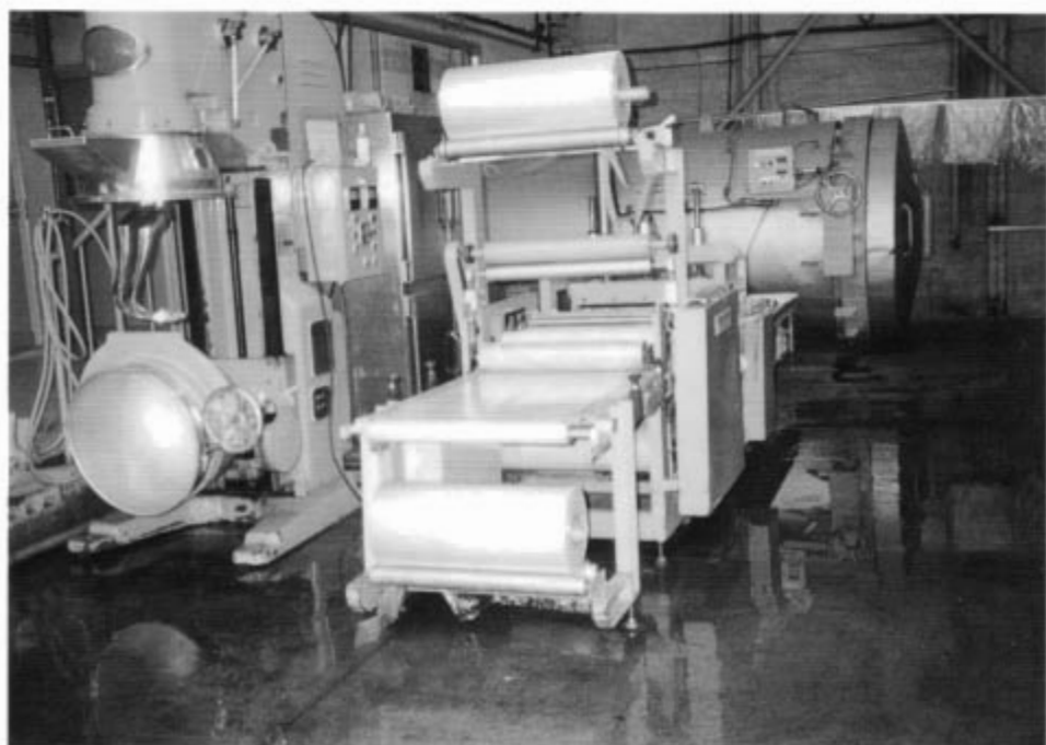
練合・圧延・成型・滅菌 写真3-4 京ヤ(株)(旧日光商事)無菌人工飼料調整装置(1989年竣工)
