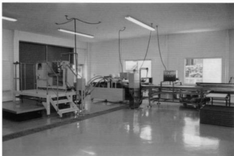
混合・加水練合・移送・圧延成型滅菌の各プロセス・システム
