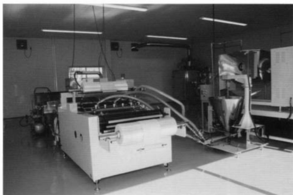
飼料練合・移送・圧延成型機 写真3-3 日原町無菌人工飼料調整装置((株)ヤナギヤ製作)
