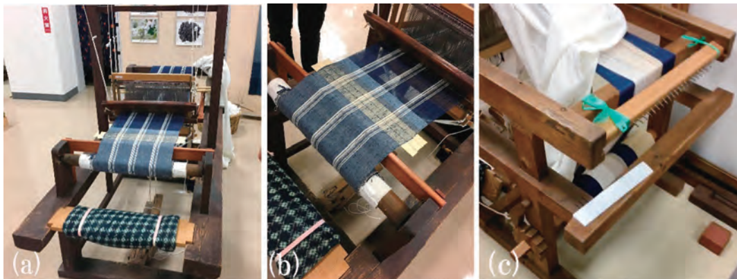
写真 7 学習会で使っている織り機 (a と b) と経絣糸を調整する仕組みの部分 (c)
